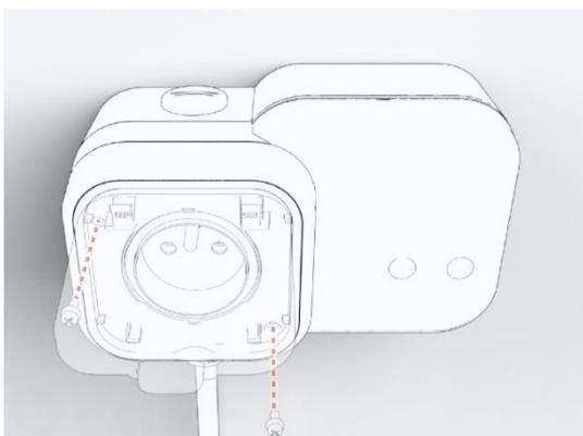
Couple de serrage des vis d'étanchéité (10) recommandé : 0,56 Nm max.
