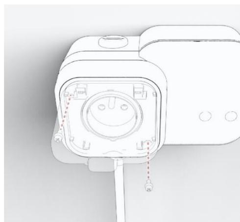
L'opérateur doit retirer les vis (10) du capot de fermeture (11).
